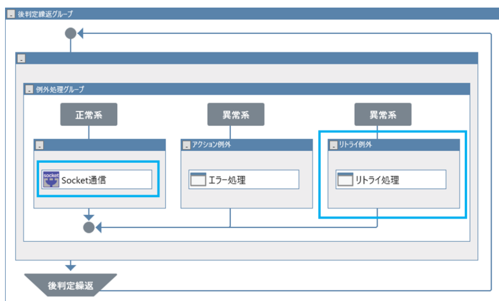
図 99-1 Socket 通信ライブラリのリトライ例外のシナリオ例
